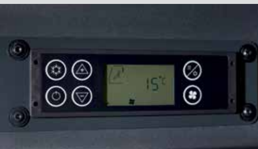
Vezérlőelemek a kabin tetejébe építve
