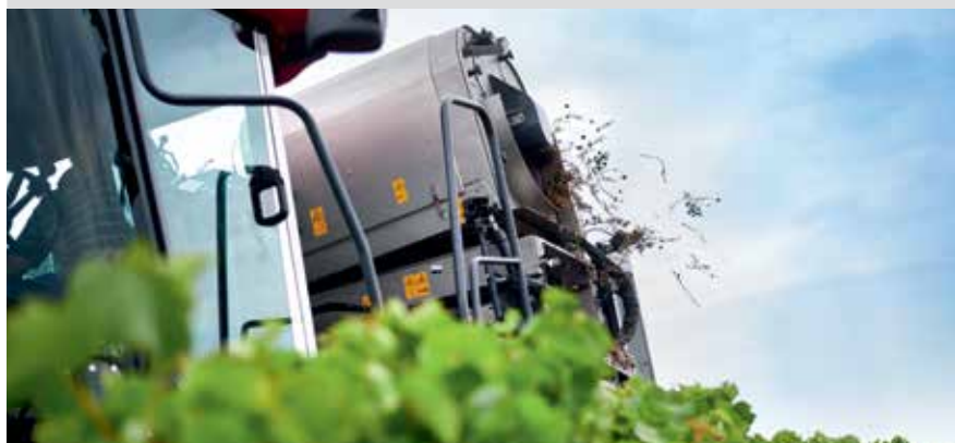
A bogyózó dobja lejtéstől függő forgásirány-változtatással van felszerelve a válogatóasztalon történő jó szőlőeloszlás érdekében.
