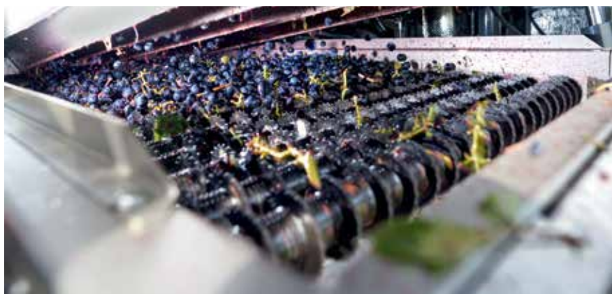
A görgők távolsága hidraulikusan állítható a fülkéből.
