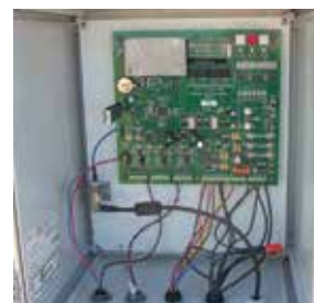
A T-L öntözőrendszer vezérlődobozának belső kialakítása
