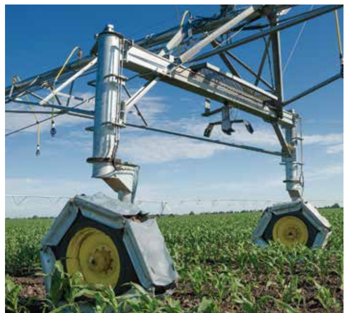
A bolygókerekes kerékagyhöz közvetlen csatlakoztatott hidraulikus meghajtás keskenyebb nyomvonalat biztosít, így a termésvesztés jelentősen csökken.
