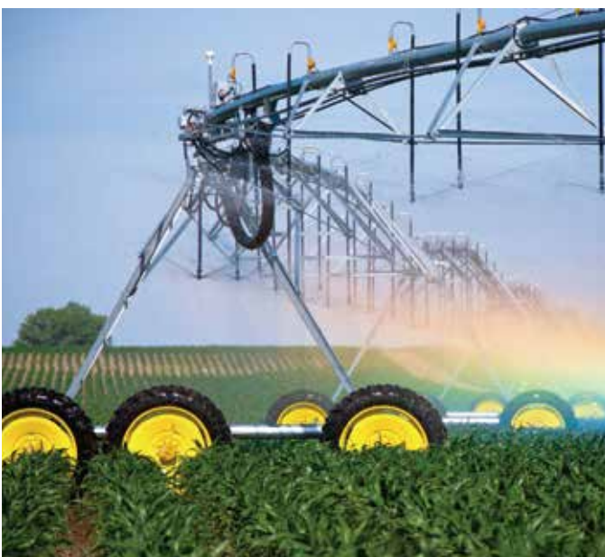
A T-L rugalmas CORNER csatlakozása továbbítja az öntözőgép egyenletes és folyamatos mozgását a körforgó tagból a CORNER-karba is.
